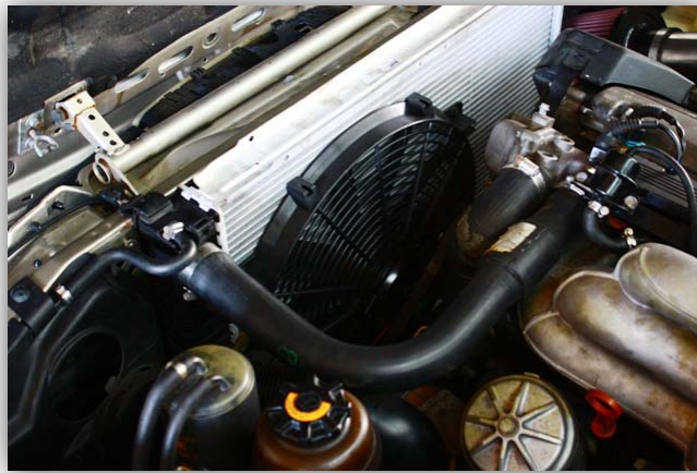
Figure 12: E34 Fan Placement
